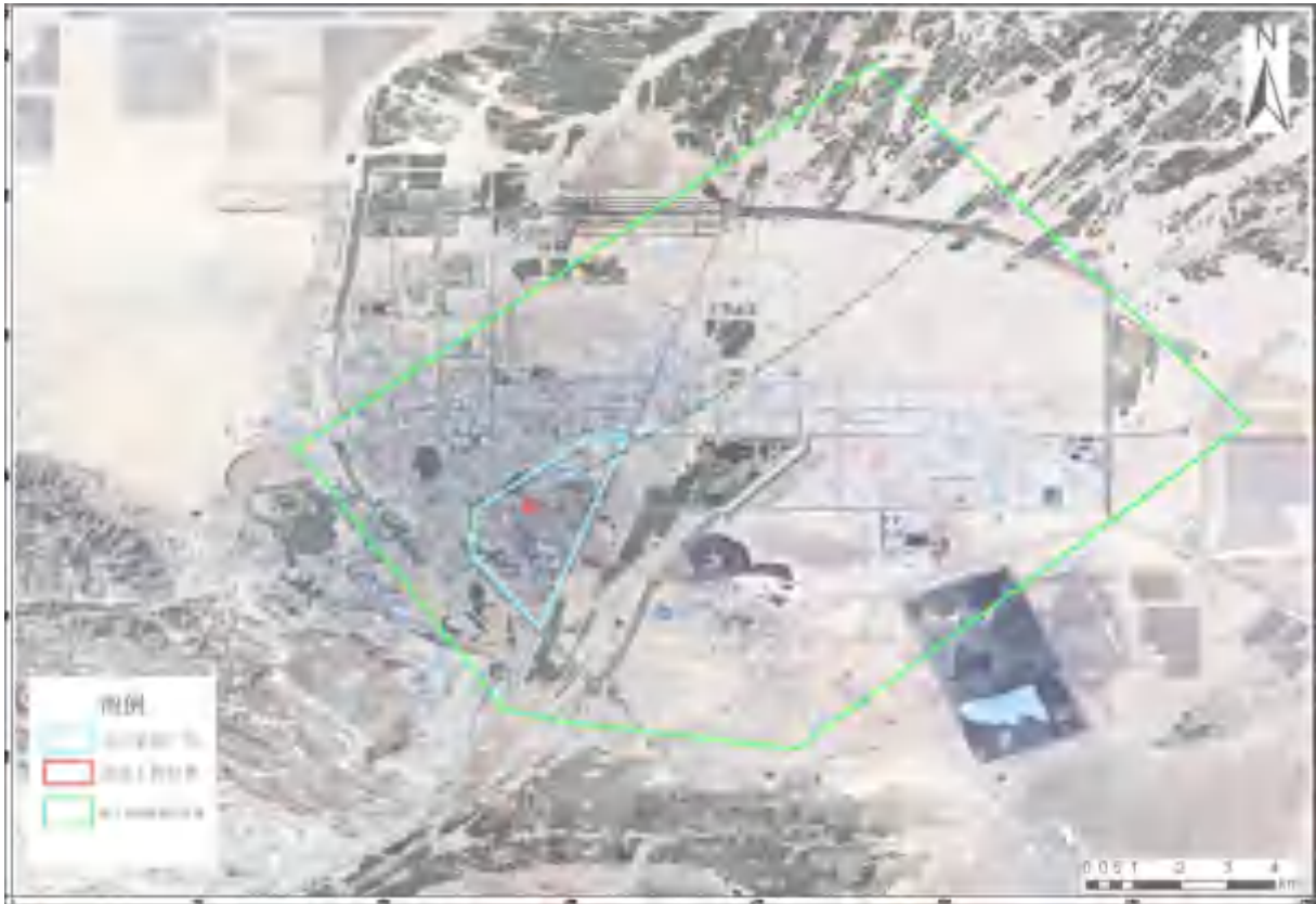
图 5.3-11 建设项目地下水示踪轨迹图
